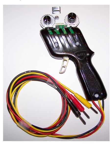
Die Montage ist recht einfach, fast alles ist geschraubt, nur die Kabel werden an die Basis Platine angelötet. Die Platinen und Hebel wurden überarbeitet und optimiert, damit die Montage noch einfacher und die Bedienung noch besser wird. Zum Bausatz gehört auch die weiche Feder, der lange und weiche Kabelsatz und der Messinghebel, welche bereits seit längerer Zeit im Shop als Zubehör angeboten wird.
